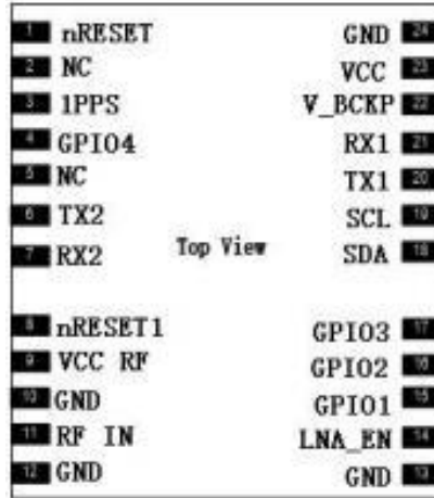
图3-1 SKG12S-09模块管脚示意图
