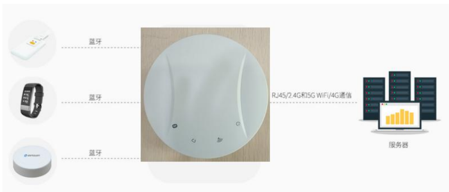
图 1.5.2 蓝牙网关采集蓝牙信标信号强度
