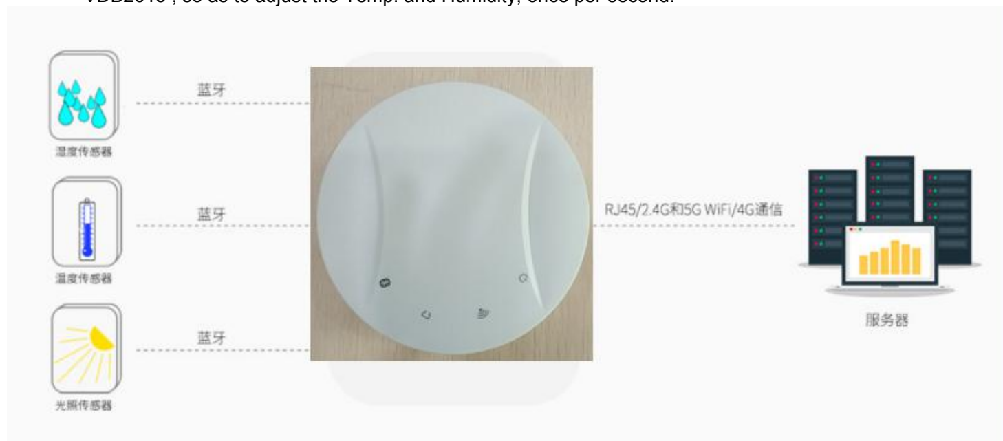
图 1.5.1 蓝牙网关采集蓝牙传感器信息
