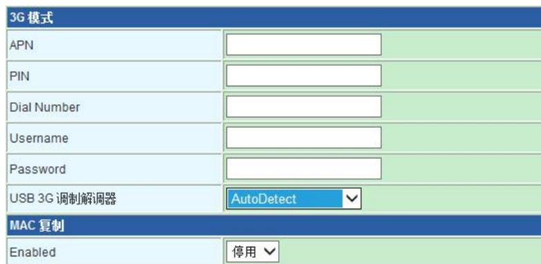
在上述表中填入运营商提供的相应 APN、PIN、Dial Number 等, 另外 USB 3G 网卡支持的型号如下所示, 暂时只支持以下型号, 若有其他型号需要支持, 请联系我司提供技术支持;
