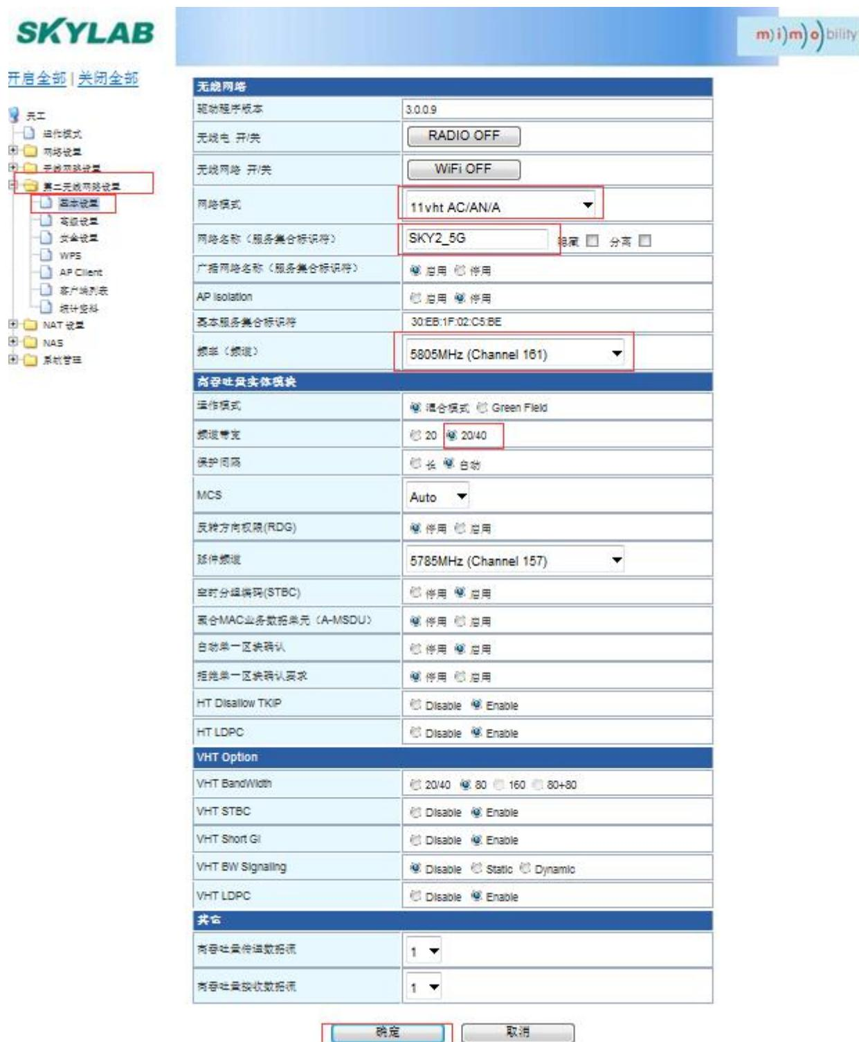
3) 5G 吞吐量测试接下来步骤与 2.4G 测试步骤大同小异, 请参考 2.4G 吞吐量测试步骤。
