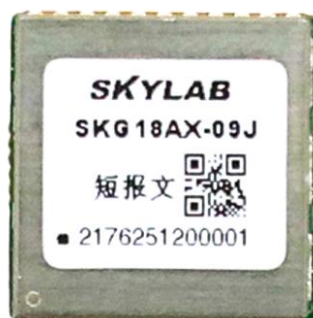
图1-1: SKG18AX-09J模块产品示意图
